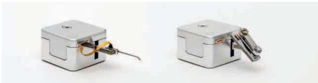
miBotの一体設計の高い剛性により、この精密機器は振動に対してに頑丈で、スムーズな動きを保証します。さらに、小型の miBot は、非常に安定した安定性を提供し、少量のサンプルでも時間の経過とともに安定した接触を確保します。
